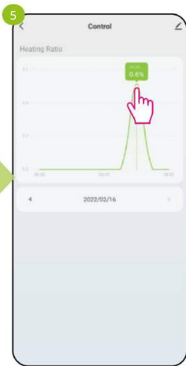
Фактор времени нагрева покажет процент и час после наведения курсора на выбранный раздел.
