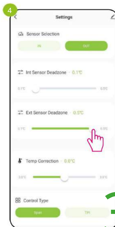
С помощью ползунка установите значение мертвой зоны датчика EXT от \pm 0,1^\circ\text{C} до \pm 0,5^\circ\text{C} .
