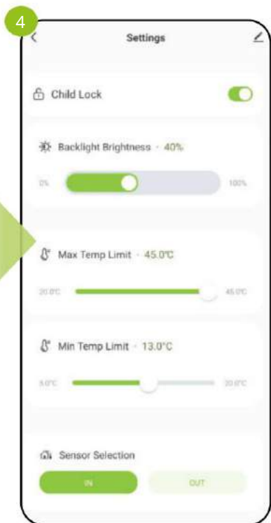
Когда ползунок выделен зеленым цветом, кнопки термостата заблокированы.
