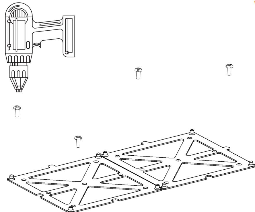
**Yapıştırma işlemi bittikten sonra belirlenen noktalardan vidalama ile aparat sağlamlaştırılır.**
