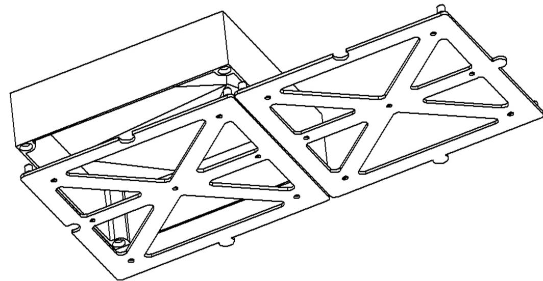
**Ürün üst parçalarının iç kısmında bulunan pim boşluk delikleri, alt montaj aparatları üzerinde bulunan pim çıkışlarına geçirilme suretiyle montaj tamamlanır.**
