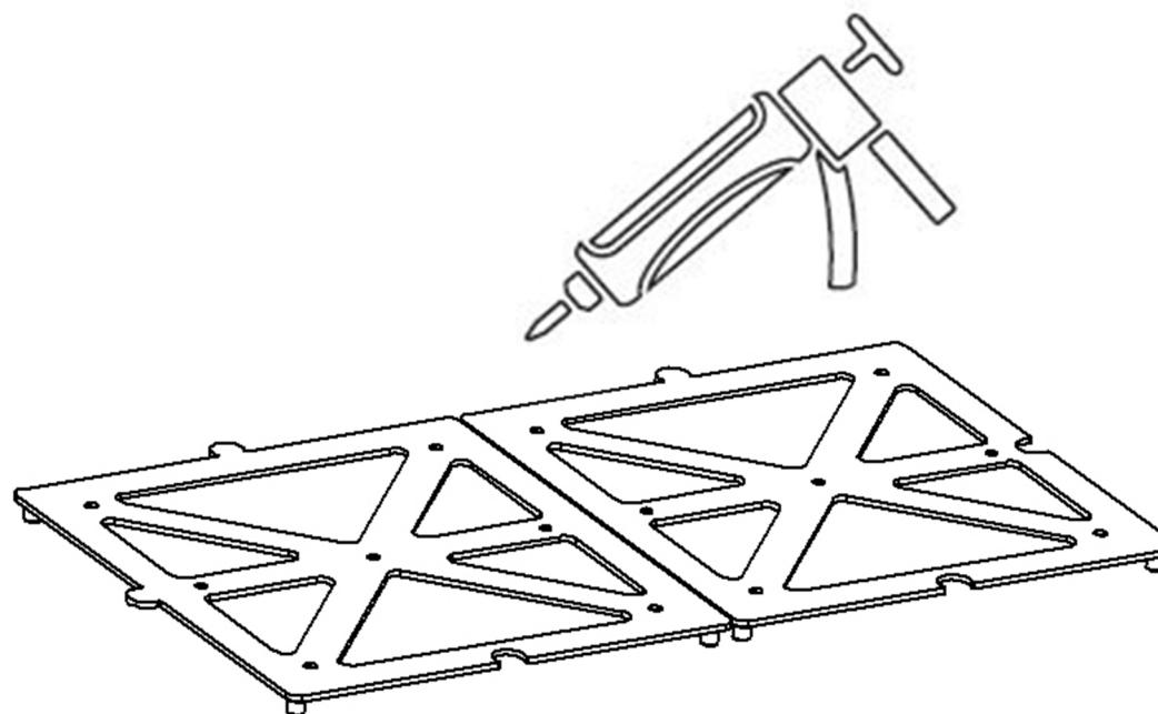
**Montaj Alt aparatının arkasına silikon sıkılarak duvara yapıştırma işlemine başlanır.**
