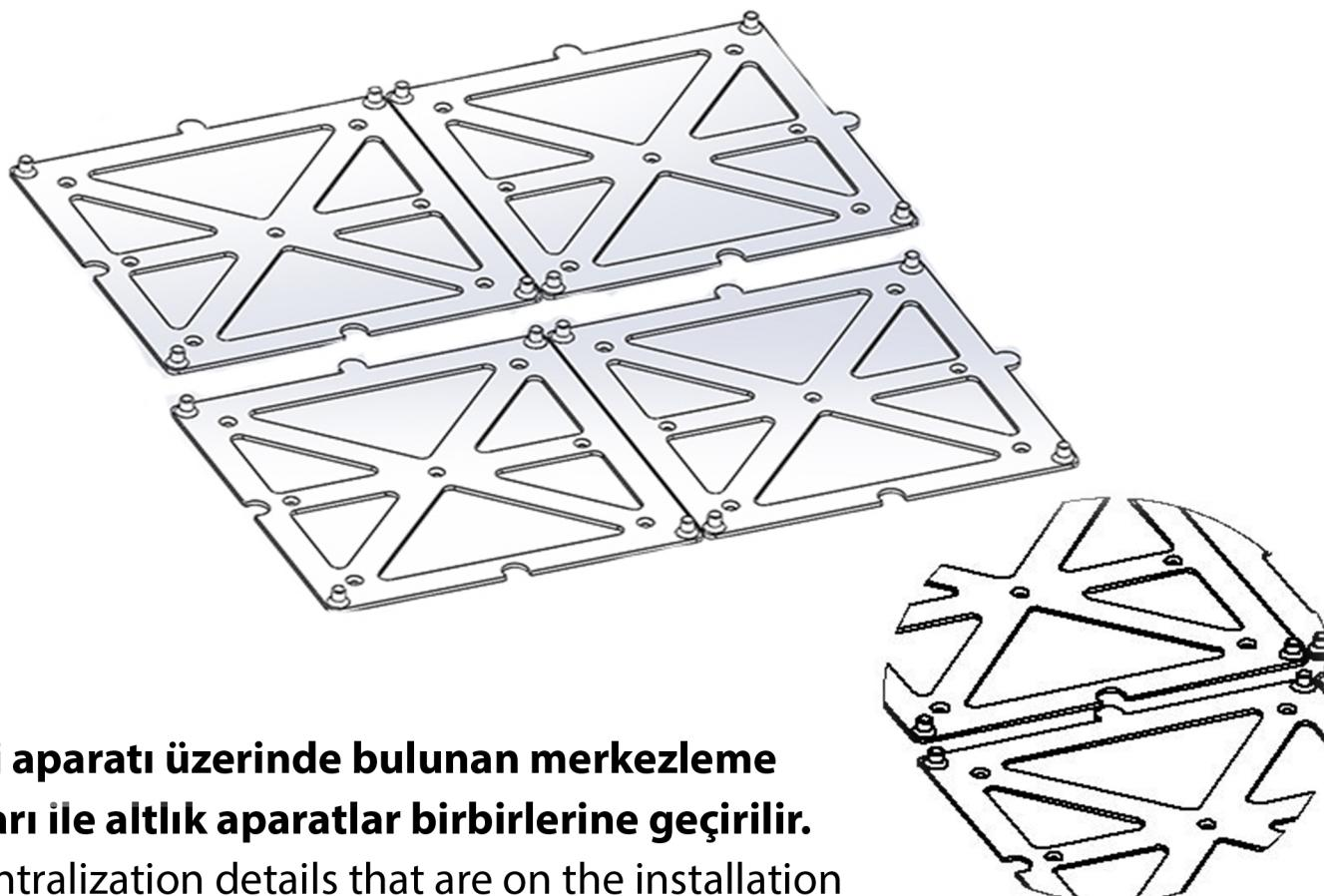
**Montaj aparatı üzerinde bulunan merkezleme detayları ile altlık aparatlar birbirlerine geçirilir.**
